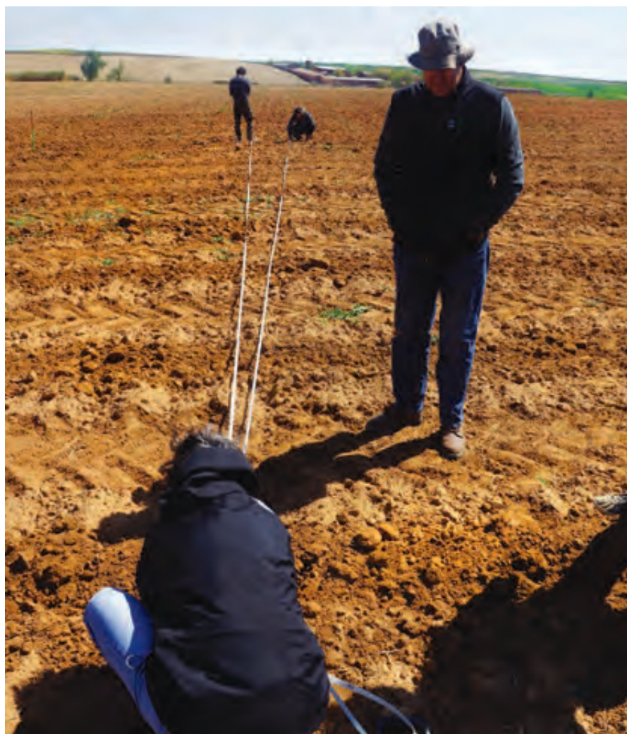
Detalle del sistema de triangulación empleado para la determinación del ancho de trabajo en diez líneas consecutivas.
